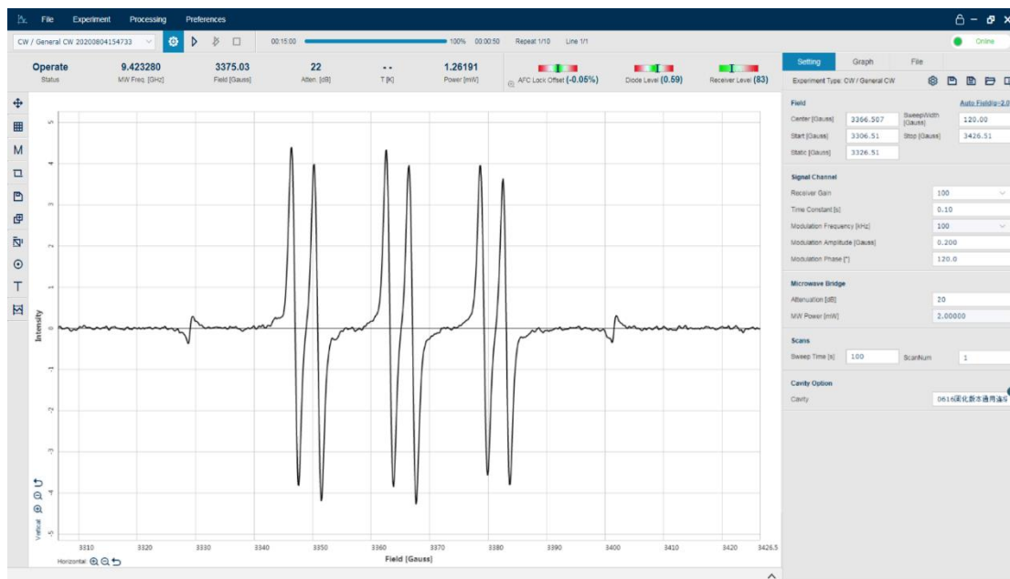
图 5. 国仪 EPR100 检测的 PBN-CH 3 O· 加合物的 EPR 谱图
